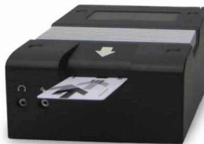
Fig. 3 – Urna Eletrônica Indra Point&Vote sem periféricos (i.e., sem tela tátil e impressora) fabricada na Espanha e usada em vários países
